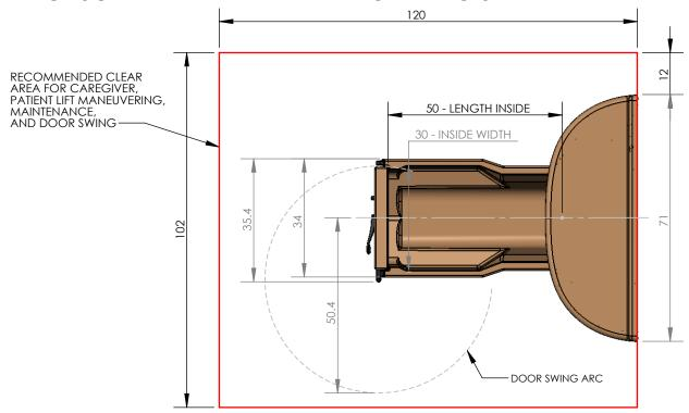
35 1/2 IN. MINIMUM DOOR OPENING WIDTH REQUIRED FOR TRANSPORTING TUB INTO THE ROOM.
